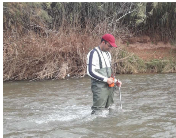
Photo 6: Méthode de moulinet utilisée dans les tronçons non-jaugés avec une vitesse importante Coordonnées X= 345 801 m, Y= 173 599m
