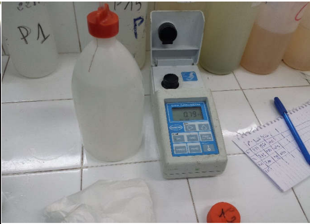
Photo 22 : un turbidimètre pour la détermination de la turbidité des eaux
