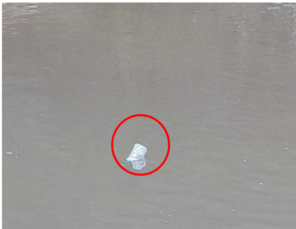
Photo 5: Méthode de flotteur utilisée dans les tronçons non-jaugés avec une vitesse faible Coordonnées X= 369 114 m, Y= 160 380 m
