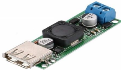
Fig.3.6. 12V-5V USB step-down module
