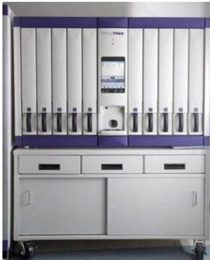
Figure 3: L'automate de détection des hémocultures positives utilisé au laboratoire de microbiologie de l'hôpital militaire Avicenne de Marrakech
