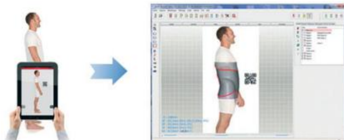
FIGURE 46 : « CAPTURE » TRIDIMENSIONNELLE INFORMATISÉE DE L'IMAGE DU TRONC DU PATIENT REMPLAÇANT LA RÉALISATION DU MOULAGE PLÂTRÉ EN NÉGATIF [42]
