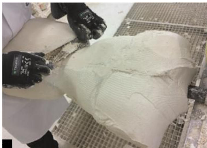
FIGURE 45: LA TECHNIQUE DE MOULAGE CLASSIQUE : RECTIFICATION DU POSITIF DU PLATRE AFIN DE PERMETTRE LE THERMOFORMAGE DE L'ORTHESE. [59]
