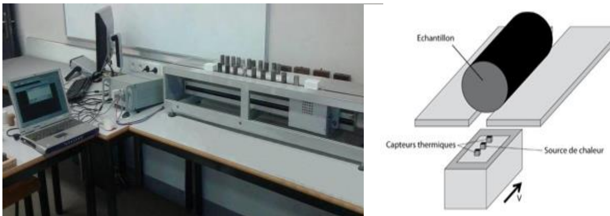
Figure. II- 11: Dispositif expérimental de mesure de conductivité thermique TCS [54].
