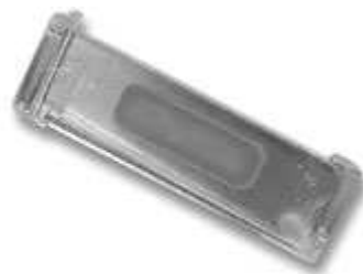
Bandelette après lavage : la coloration a disparu, le lavage est efficace.
