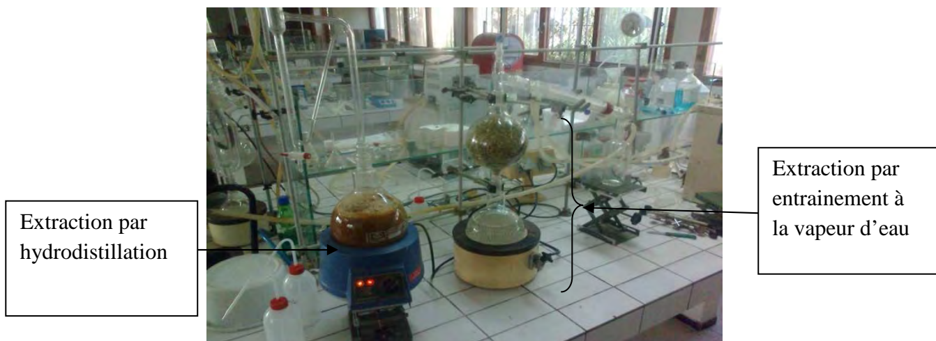
Fig. 7 : Extraction des huiles essentielles [photo du laboratoire de génie des procédés de la faculté des Sciences d'Agadir]
