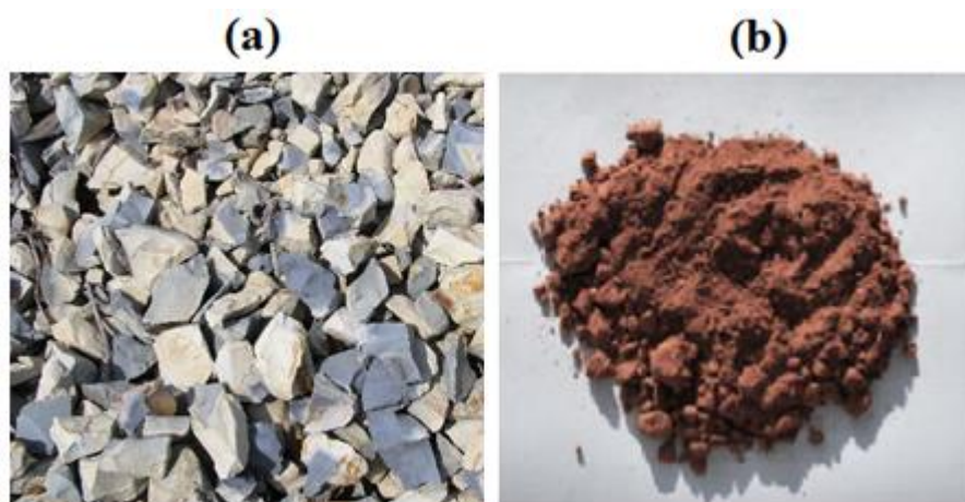
Figure II. 8. Adsorbants utilisés pour le traitement du concentrât ; (a) adsorbant naturel d'Opoka et (b) Résiduel ferrique du lavage à contre-courant
