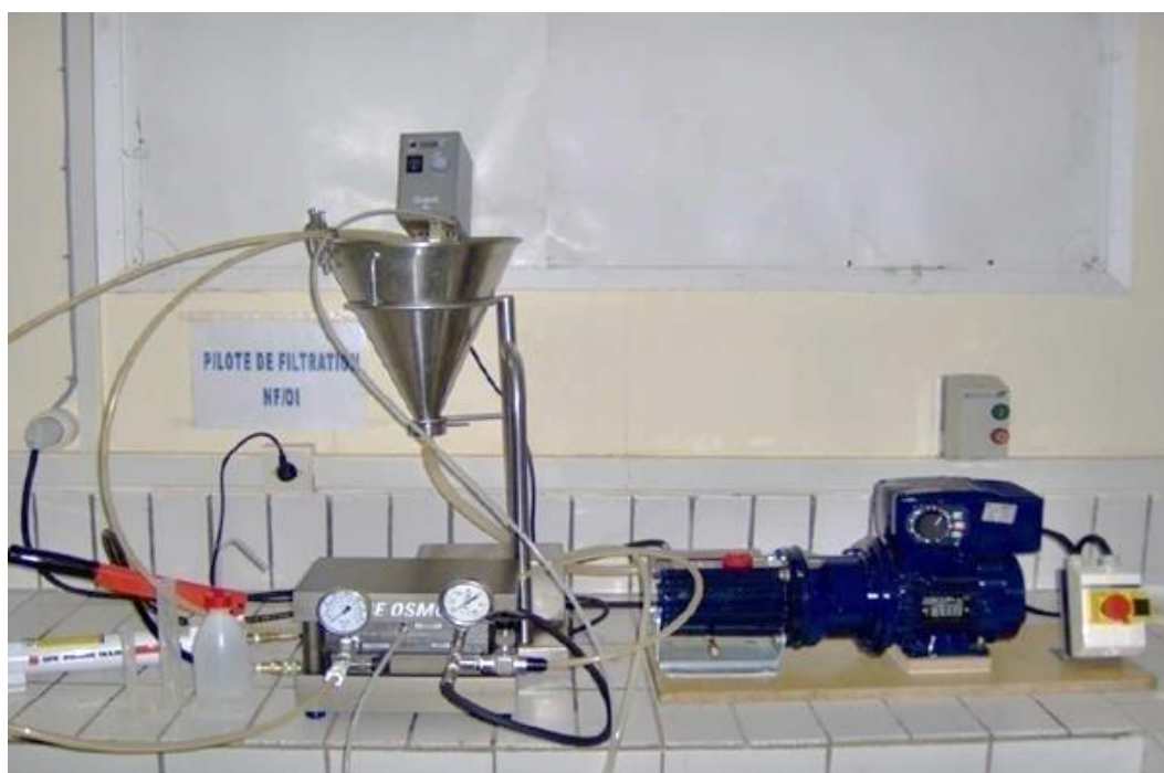
Figure II. 1. Photographie du pilote de filtration NF/OI, LCA-FSTF
