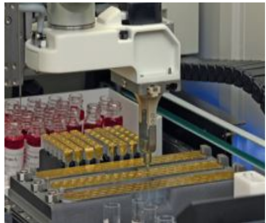
Figure 61 : Perçage des racks ID-Diluent
