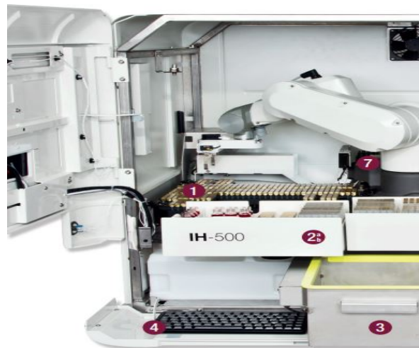
Figure 58 : Image illustrant le design interne de l'automate IH500
