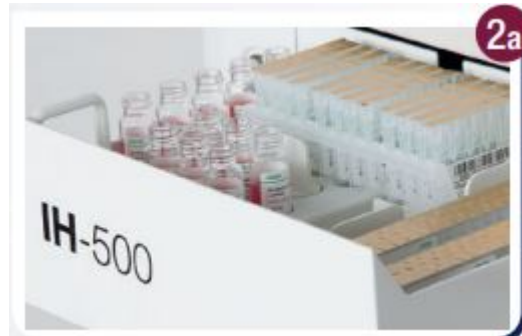
Figure63 : Tiroir pour un chargement flexible
