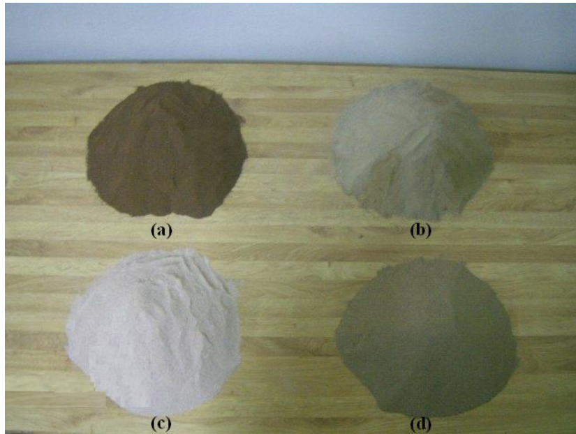
Figure 2.18 Echantillons des sols étudiés : (a) limon silteux, (b) limon beige, (c) limon calcaire et (d) le sable.
