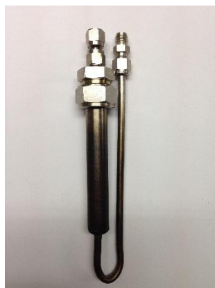
Figure II-10 Image photographique du réacteur en acier inoxydable.
