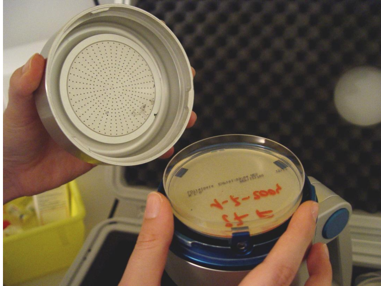
Figure 1 : Appareil de prélèvement d'air : tête + boîte de culture sur Malt [Photo du Laboratoire de Parasitologie Mycologie, HMIM V]
