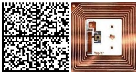
Figure I-6 : Code-barres matriciel Datamatrix (gauche) et transpondeur RFID (droite)
