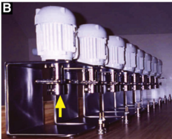
Figure 24: Schéma simplifié du procédé de la technique Nano-Crystal. A : est un diagramme schématique du processus de nanosynthèse utilisant la technologie de broyage humide. La chambre (avec des milieux de broyage) est chargée avec la suspension brute d'un composé faiblement soluble dans l'eau. Lorsque le moteur a activé les médias, les particules de médicament et les parois de la chambre apportent des forces de cisaillement / d'impaction importantes, ce qui entraîne une réduction de la taille des particules de 100 microns à l'échelle nanométrique. Les milieux de broyage sont retenus dans la chambre à l'aide d'un tamis et le composé faiblement soluble dans l'eau dans une solution de stabilisant à base d'eau peut être traité en mode discontinu. B : montre une série d'unités de broyage de support à échelle exploratoire qui peuvent être utilisées pour traiter des quantités milligrammes d'actifs. C : une unité de fabrication commerciale à grande échelle est montrée. Cette unité est capable de traiter 500-100 kg d'actif par lot[53] .
