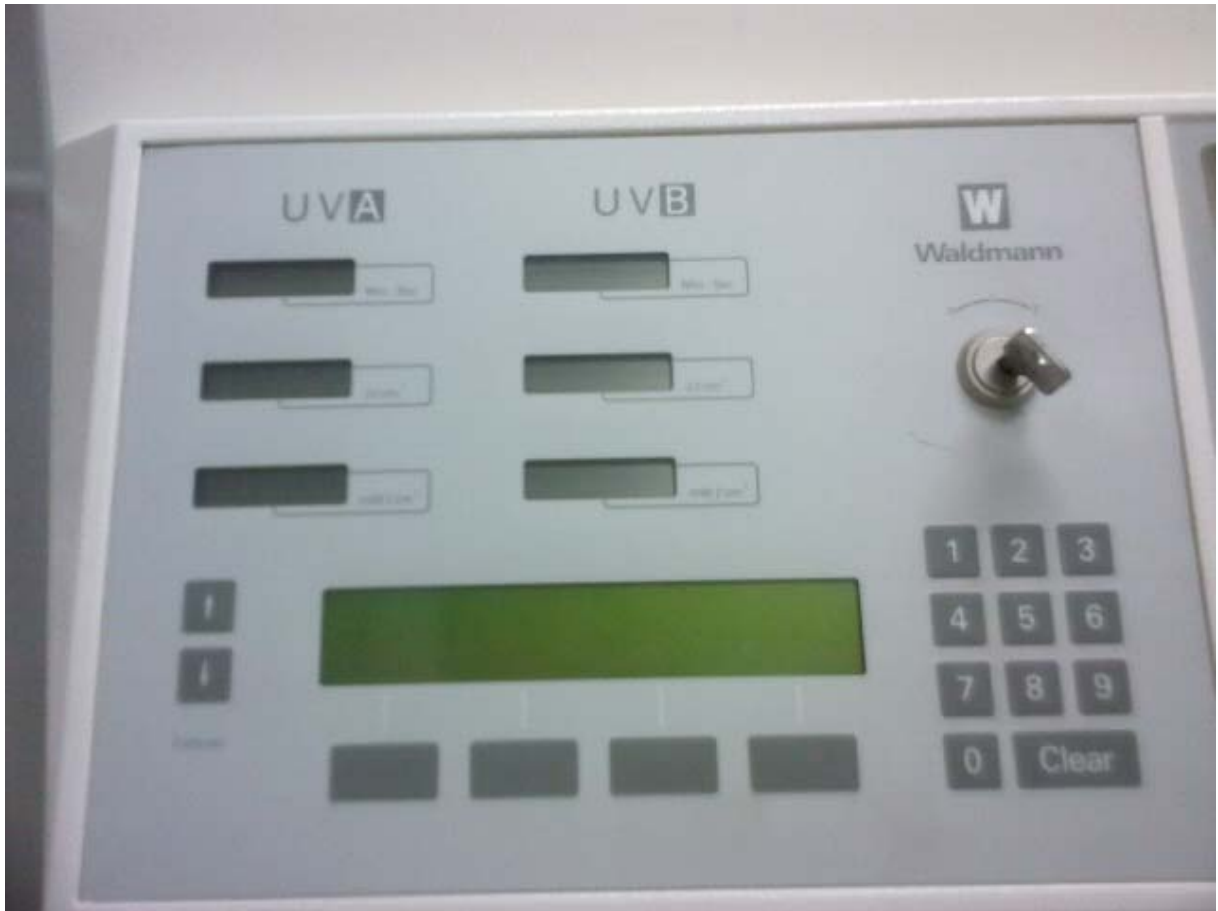
Fig.2 : Commande électronique qui permet l'utilisation séparée soit du secteur UVA ou du secteur UVB
