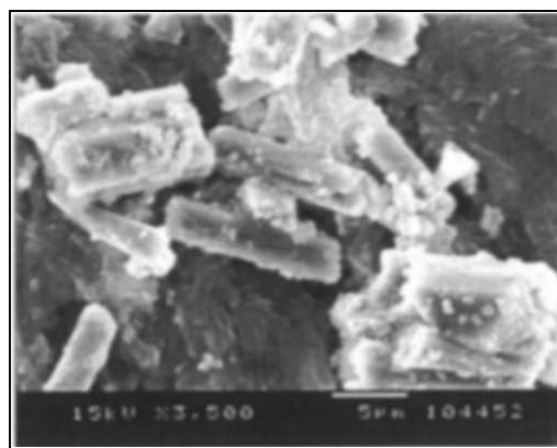
Figure I.3 : Transformation de l'aragonite métastable à la température ordinaire en calcite [3]
