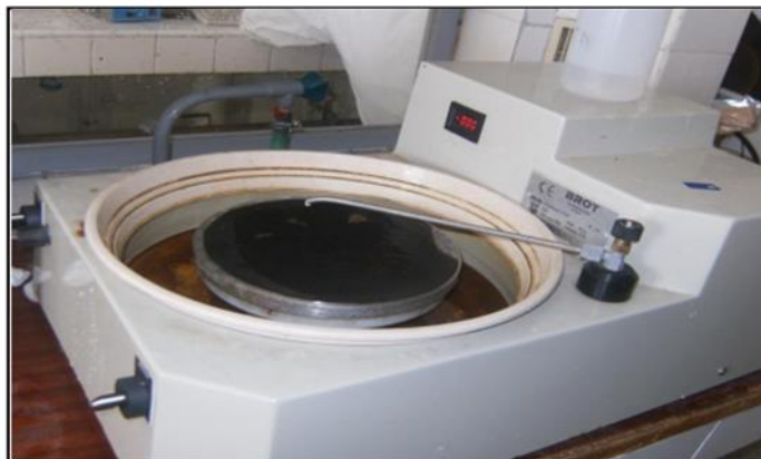
Figure II.1: Appareil de polissage manuel vitesse en variable de 100 à 700 tours/min.
