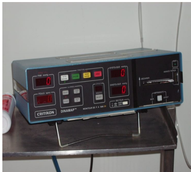
Fig.18 : DYNAMAP (mesure de la PA, PAM, FC)
