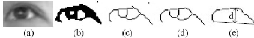
Figure 2.3 – Extraction de l'état de l'œil (Zhang et al. , 2008). (a) Image de l'œil ; (b) Binarisation ; (c) Raffinement ; (d) Contour fin ; (e) Distance entre les paupières inférieure et supérieure
