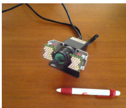
Figure 4.10 – L’unité d’acquisition Smart Eye AntiSleep composée d’une seule camera et de deux sources de lumières infrarouges (Bretzner et Krantz, 2005)
