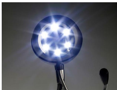
Figure 3.26 – Web caméra avec un éclairage intégré
