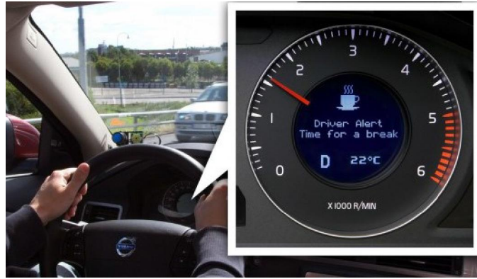
Figure 1.5 – Signal visuel émis par le système DAC en cas d'hypovigilance
