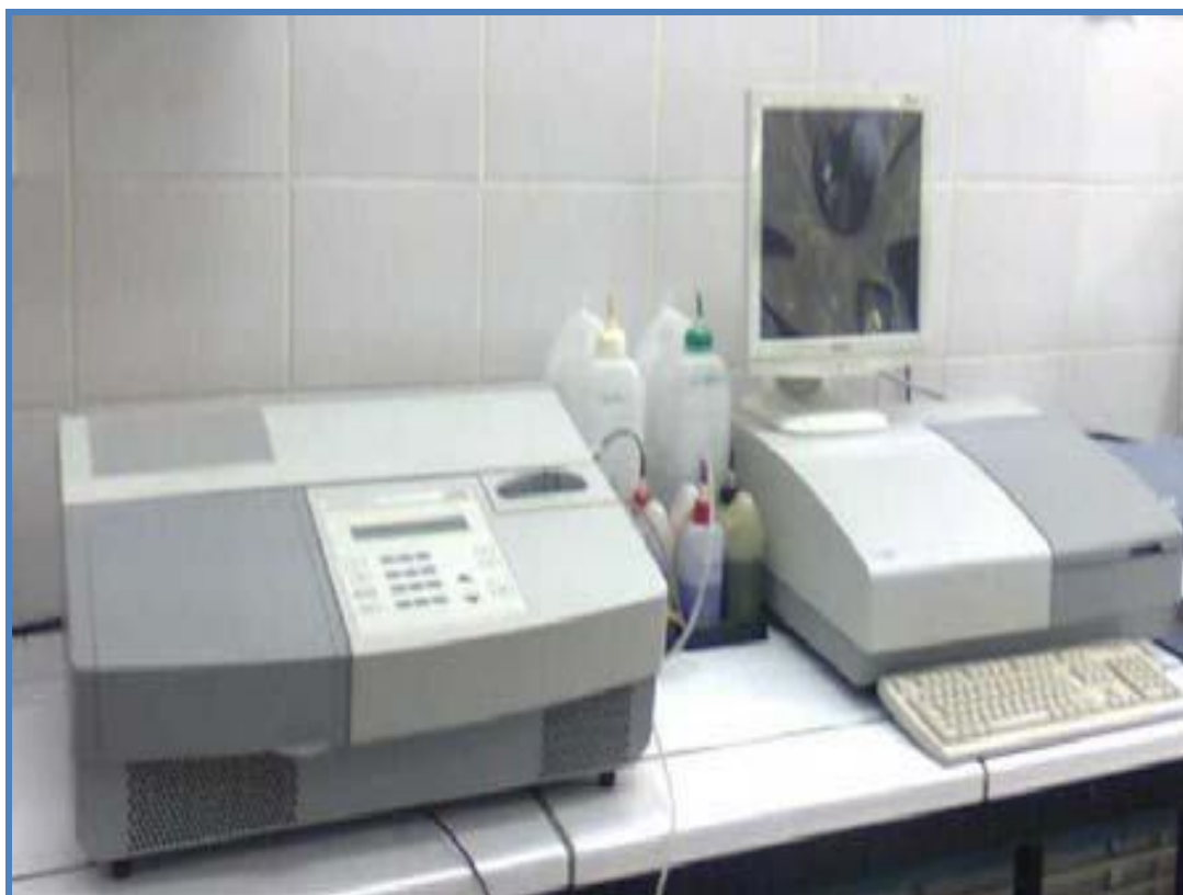
Figure 2: Automate Hydrasys® de Sebia (Laboratoire de biochimie, HMIMV)
