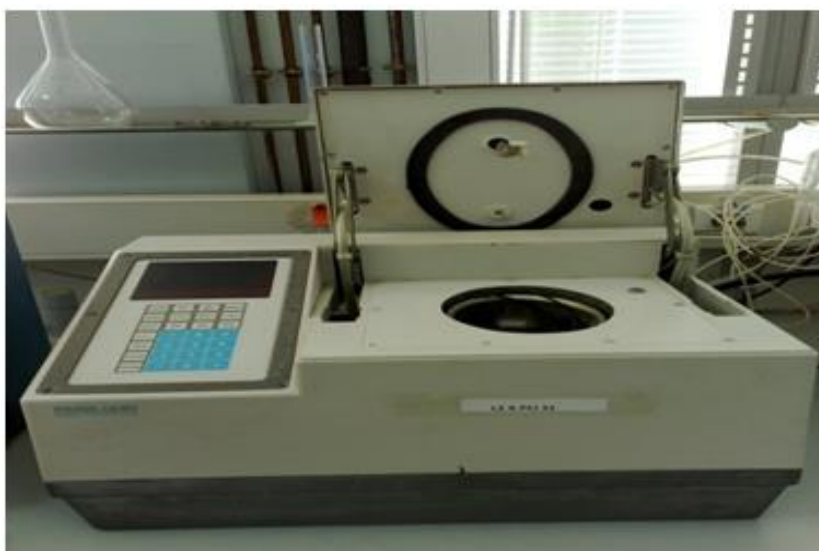
Figure III- 14 : Appareil pour la détermination de Pouvoir Calorifique.
