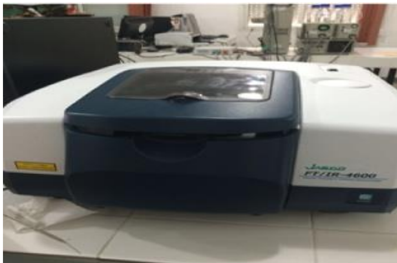
Figure III- 6 : Appareil de spectroscopie (FT/IR JASCO 4600).
