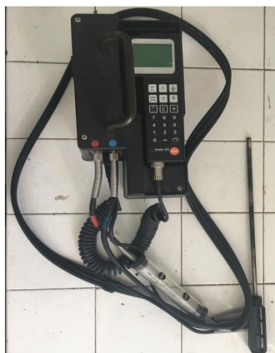
Figure VI-5 : Analyseur (Testo 350XL) de CO x , NO x et SO 2 .
