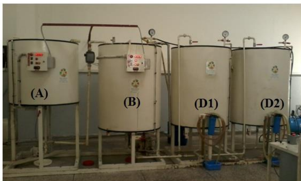
Figure VI- 1: Dispositif expérimental pour la production du biodiesel à une échelle de 400 L.
