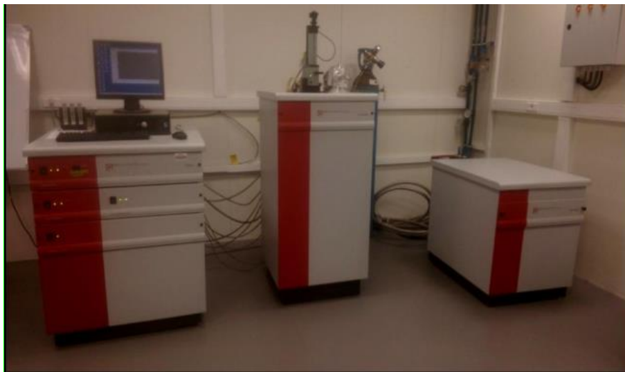
Figure II- 16: Vue d'ensemble du Magnétomètre MPMS-XL7.
