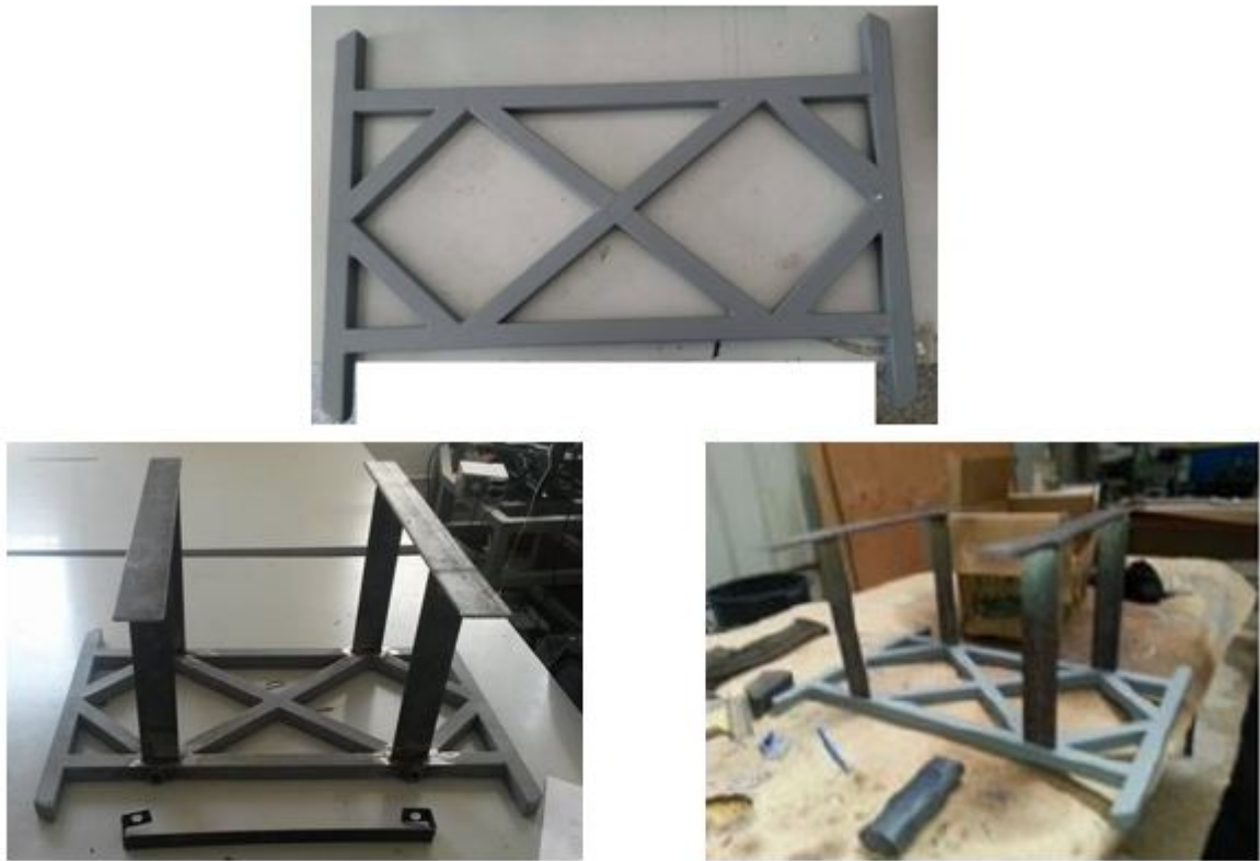
FIGURE II.6 – La structure de châssis métallique de la plateforme mobile pendant l'assemblage
