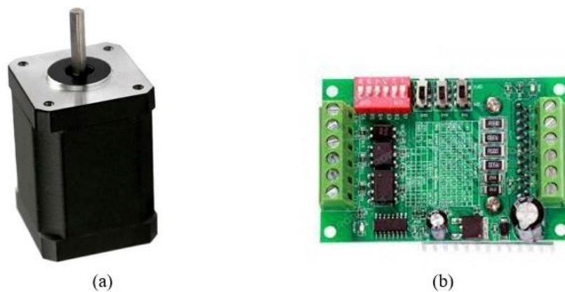
FIGURE II.24 – (a) Moteur pas à pas 17HS4401 Nema17 et (b) carte de puissance TB6560 Driver 3A
