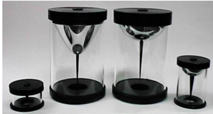
FIGURE I.24 – Différents types de miroirs composant un capteur catadioptrique
