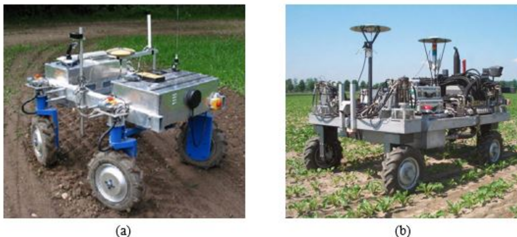
FIGURE I.4 – (a) Autonomous Plant Inspection (API) (b) Un robot autonome pour le désherbage.
