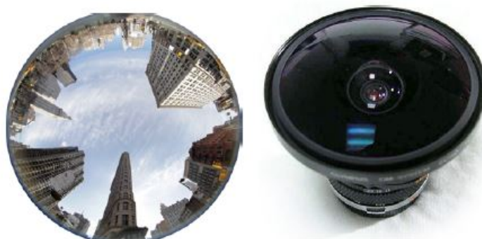
FIGURE I.23 – Image obtenue par objectif fisheye à gauche, lentille fisheye à droite
