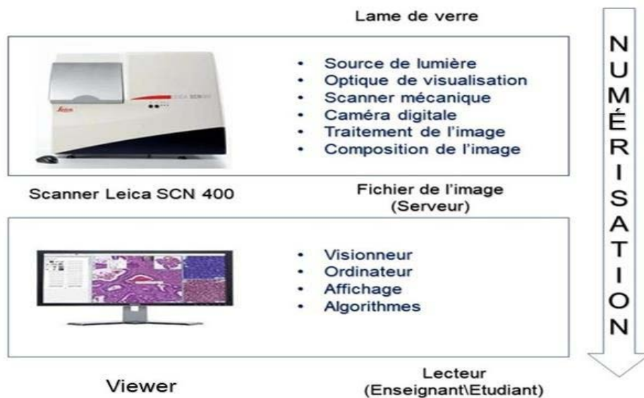
Figure 26 : Processus de numérisation d'une lame de verre entière au service d'anatomie pathologique du CHU Mohamed VI via le scanner LEICA SCN 400.
