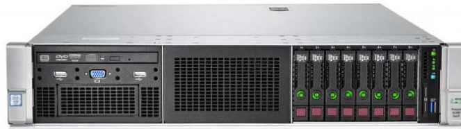
Figure 5 : Le serveur ESXI de la FMPM HP Proliant DL380 G9 de processeur Xeon E5-2620V3 2.4 GHz.
