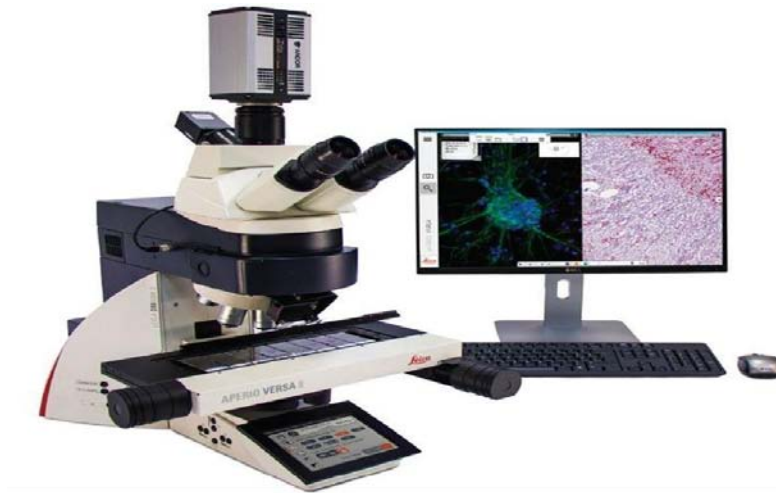
Figure 22 : Microscope robotisé, la caméra montée sur le microscope est reliée à une unité d'ordinateur.
