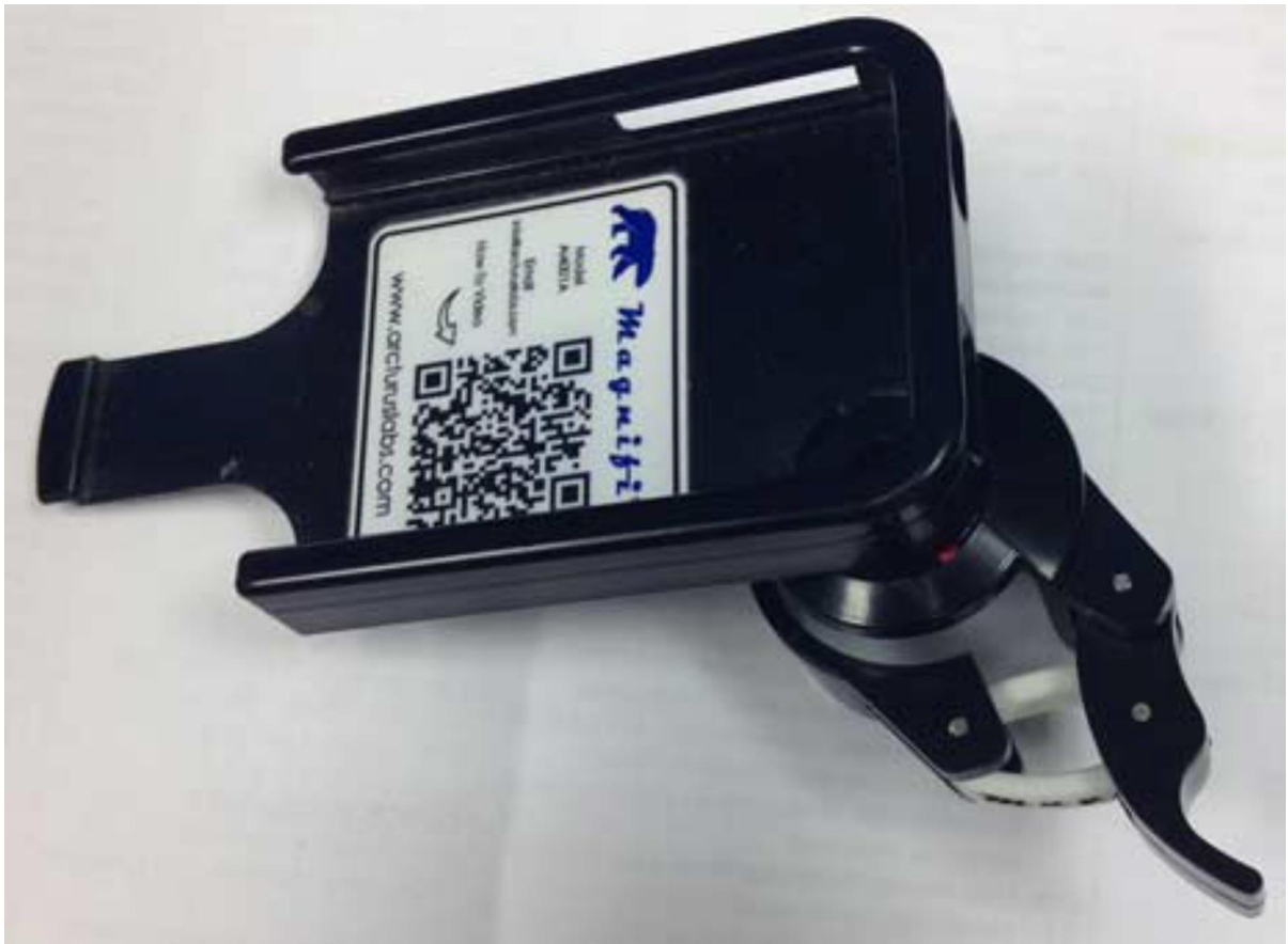
Figure 12: Photo d'un adaptateur qui fixe directement un smartphone à un microscope oculaire[32].
