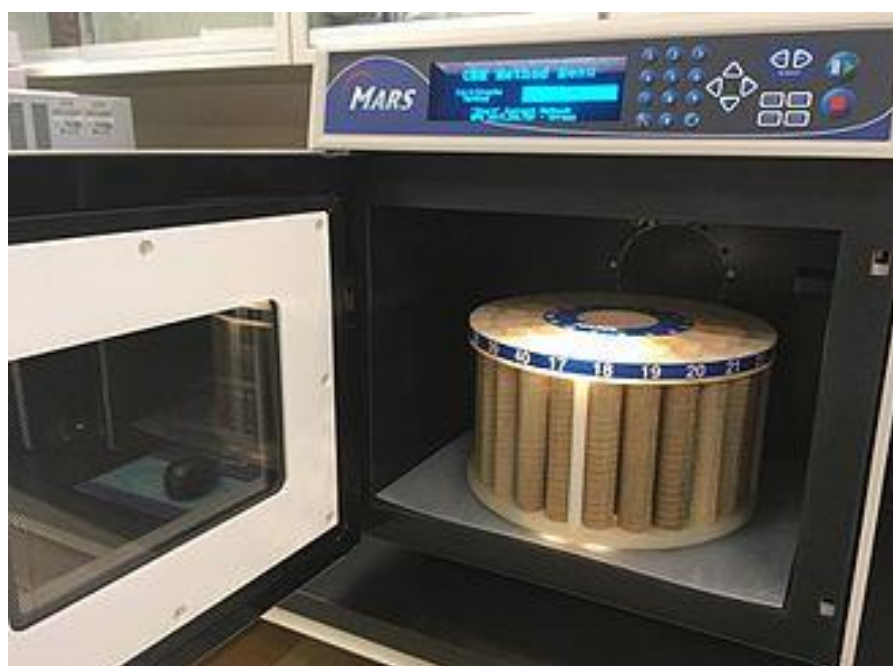
Figure 10: Intérieur d'une micro-onde à digestion acide
