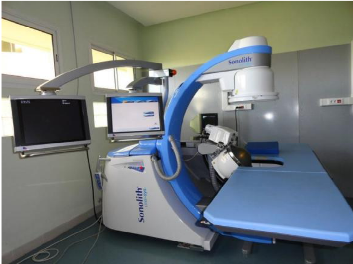
Figure 7 : Le lithotriteur à source électroconductive Sonolith i-sys du service d'urologie CHU HASSAN II de FES
