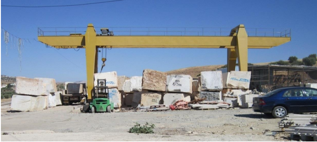
صورة رقم 28: رافعة ضخمة لحمل الحجر بمصنع الحجر بمنطقة واد أمليل
