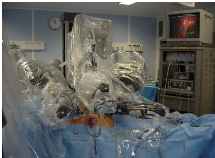
Figure 45: Disposition des bras du robot au-dessus du patient et positionnement des trocars.
