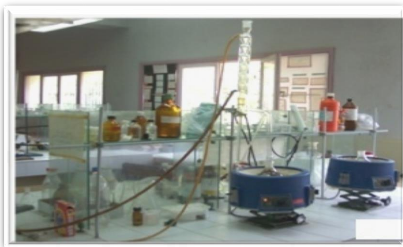
Figure 67 : le montage de distillation utilisé: appareil de Clevenger.
