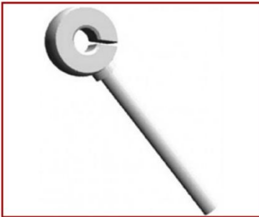
Figure 75 : Piston Téflon® [169]. Diamètre du fût : 0,4 mm ; longueur : 4,5 mm.
