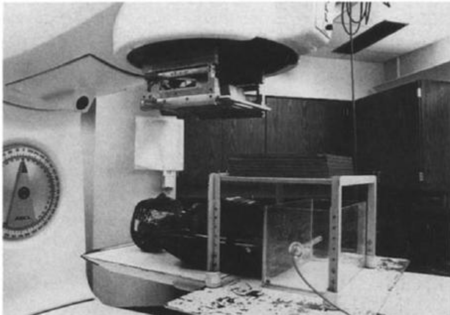
Figure 1: Simulation de la géométrie de la patiente et mesure de la dose totale et la distance du fœtus des bords des champs d'irradiation. [31]
