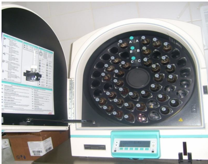
Figure 1 : Bactec 9050® et Flacon Mycosis ICF® (Photo du laboratoire de Parasitologie, HMIM V)
