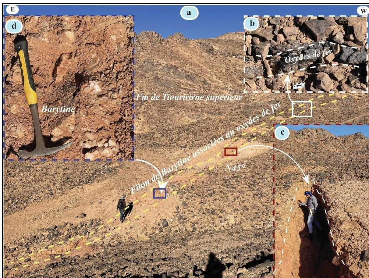
Figure III-7. Filon NE-SW minéralisé en barytine et en oxydes de fer dans les formations de Tiouririne supérieure.
