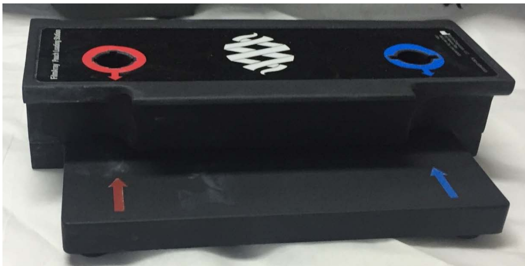
Figure 4 : station de chargement de la cassette
