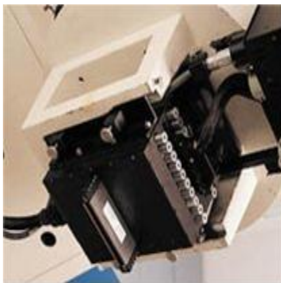
Figure 30 : Le système de tomothérapie en série Mimic de Nomos qui consiste en un MLC binaire qui s'attache à la base de la tête de l'accélérateur.
