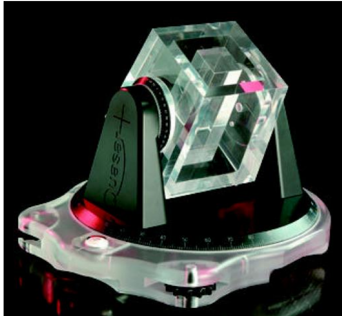
Figure 49 : fantôme QUASAR utilisé pour valider les représentations graphiques des faisceaux sur différents plans (axiaux, coronaux, sagittaux et obliques) ainsi que les vues BEV et DRR. Les axes de rotation verticale et horizontale permettent de simuler les rotations de table et de bras d'un accélérateur respectivement. À l'intersection des deux axes, une bille submillimétrique de haute densité représente l'isocentre de l'accélérateur.
