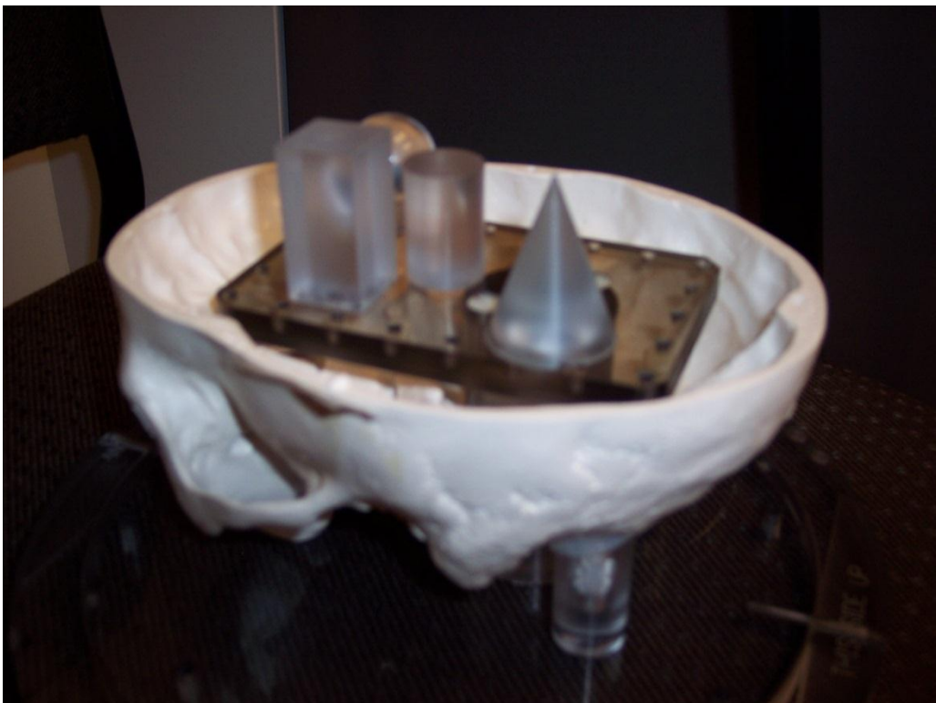
Figure 48 : Vue des structures internes du fantôme de crâne utilisé pour valider les outils de dessin, de définition et d'expansion des volumes.
