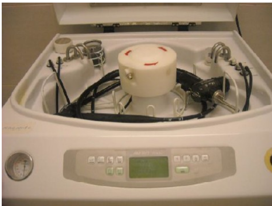
Figure 6 : Endoscope dans « un laveur désinfecteur » (Endoscope Washer Merit 9000) (Service de pédiatrie du CHU–Hassan II DE Fès).
