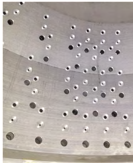
Figure 38 : A droite : Photo de la cape en tungstène des appareils de nouvelle génération. A gauche : Image d'une partie de la cape en tungstène avec les perforations des différents calibres pour un secteur (24 x 3 trous).
