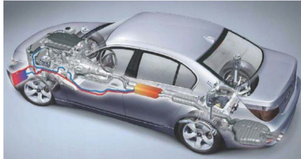
FIGURE 1.28 – Conception d'un générateur thermoélectrique produisant de l'électricité à partir de la chaleur perdue au niveau du pot d'échappement d'un véhicule (source BMW).
