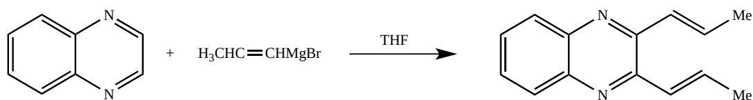
Schéma 39 : Synthèse de la 2,3-diallyl-1,2,3,4-tétrahydroquinoxaline par réaction de substitution nucléophile.
