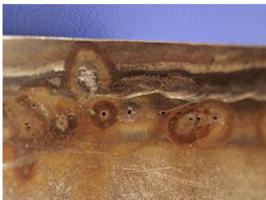
Figure 68 : Corrosion par piqûres.
