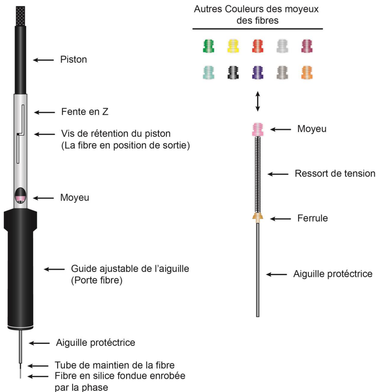
Figure 5: Support d'échantillonnage manuel et les fibres pour la microextraction sur phase solide (SPME).
