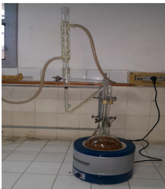
Figure 25: Montage de l'hydrodistillation au laboratoire (Clevenger)
