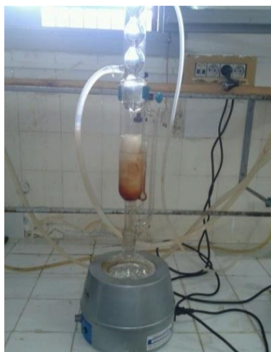
Figure 27: Montage d'extraction par Soxhlet utilisé au laboratoire LMNE
