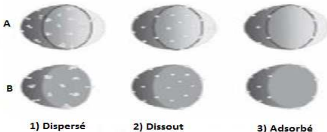
Figure 12. Mécanismes d'encapsulation : le principe actif est dispersé, dissout, ou bien adsorbé : A) capsules et B) sphères.
