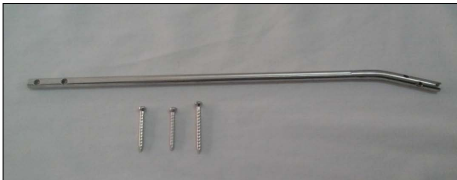
Figure n°36 : Clou scié avec ses vis de verrouillage proximales et distales
