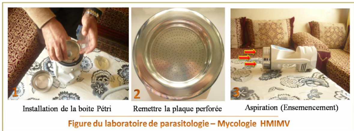
Figure 5 : Prélèvement et ensemencement des bioaérosols par impaction sur milieu solide (gélose à l'extrait de MALT) en boîte de Pétri.
