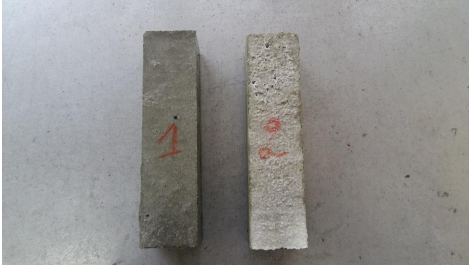
Figure 6.12. Prismatiques spécimens ( 40 \times 40 \times 160 mm) de mortiers à l'âge de 28 jours pour l'hydratation dans l'eau (1) et dans l'air (2).
