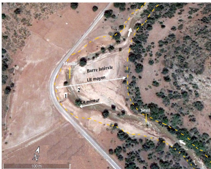
Figure 3.20 : exemple de mouille et seuil dans le lit de Tizguit observé à l'amont des gorges Larjem (image Google Earth 2021). 1 : Rive concave ; 2 : Rive convexe.
