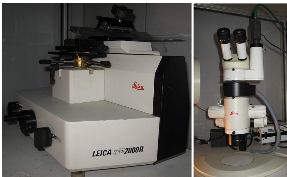
Fig. II.2: Équipement utilisé pour l'observation microscopique. A gauche : le microtome. A droite : le microscope optique équipé d'une caméra.
