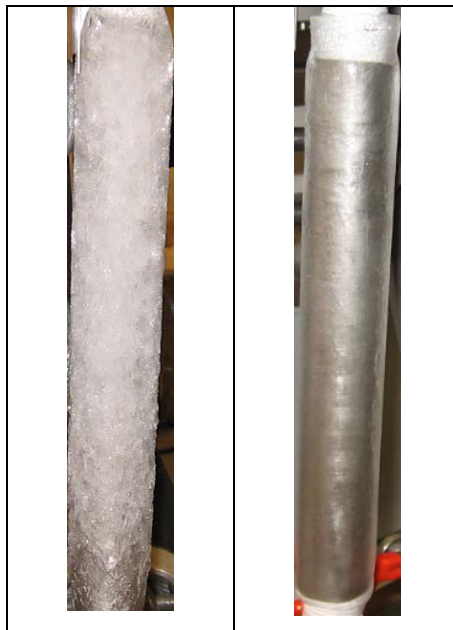
Fig. II.9: Aspect visuel de la couche de glace obtenue pour C_i=35\text{g/kg} ; a) à gauche en absence de gradient thermique ; b) avec un gradient thermique de \Delta T=2,2^\circ\text{C}
