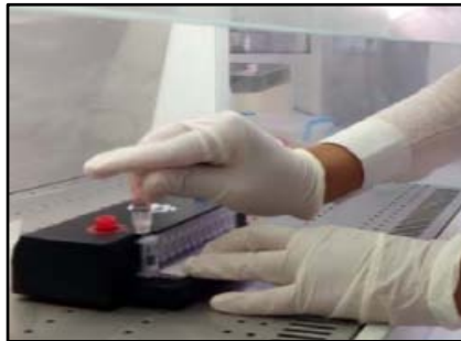
Figure 11: Le mélange échantillon / tampon est injecté dans l'orifice d'échantillon de la cassette.
