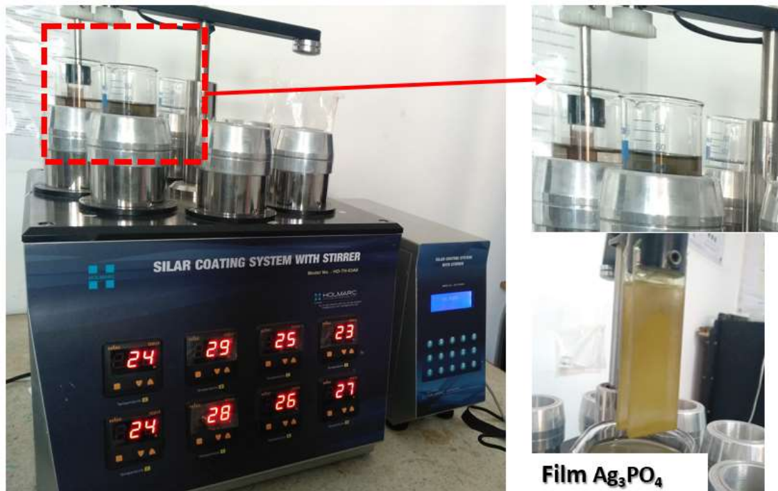
Figure II.9. Dépôt des couches minces à l'aide de la technique SILAR installée dans le laboratoire LPMS de Kenitra
