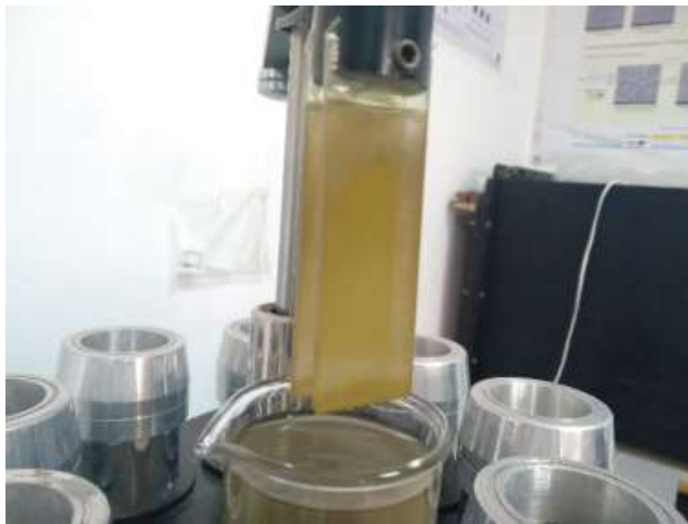
Figure VI.10. La couche mince \text{Cu-Ag}_3\text{PO}_4 déposée par la technique de SILAR (LPMS, Kenitra)
